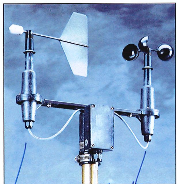
Girouette indique la direction d'où vient le vent! Anémomètre indique la vitesse du vent
